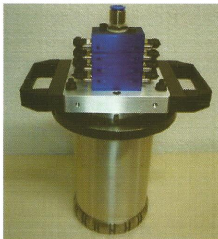
Durchmessern 140H6, 2x8 Luftmessdüsen für Rundheit für LKW Motorblock V8.
