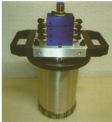
Durchmessern 140H6 gemessen mit 2x8 Luftmessdüsen für Rundheit an LKW Motorblock V8.
