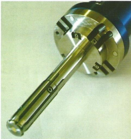
Messen von 3 Durchmessern und 1x Tiefe in einem Schritt. Ventilsitz und Ventilfehrung
